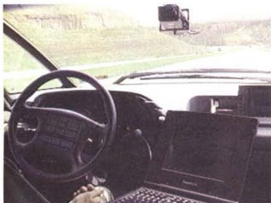
Figura 10 - Una foto dell'interno della Pontiac dotata dei dispositivi elettronici per la guida automatica progettati in NavLab 5. Si nota la telecamera anteriore sul parabrezza ed il PC portatile dove gira l'interfaccia uomo-pilota automatico.
